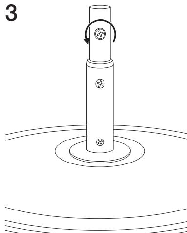
從支撐柱背面取下風扇頭的固定螺絲。
