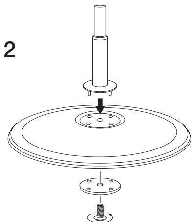
如圖所示，使用螺絲栓緊支撐柱與底座
